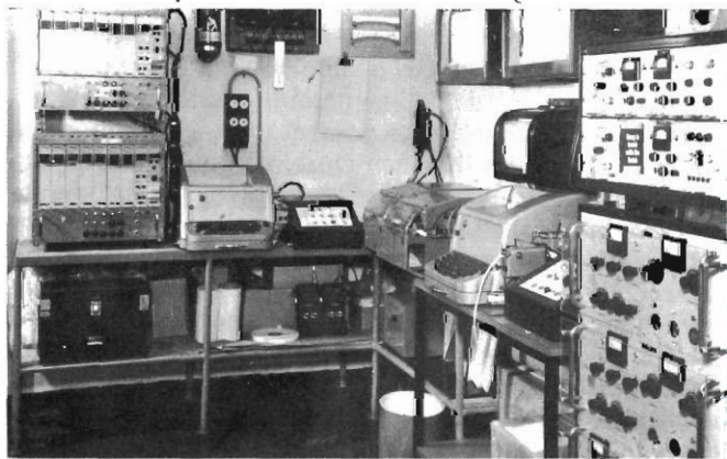
Cabina radar della piattaforma di foratura "Transocean II" nel mare del Nord. A sinistra, sono visibili due unità Simplex-Tor e a destra, i ricevitori canalizzati Philips ed i trasmettitori che vengono utilizzati per i collegamenti radio.
